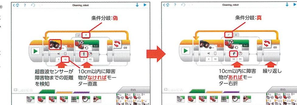
右の図はセンサーが障害物を感知して回避するプログラムの画面とモデルの動きを示しています。このようにお掃除ロボットや災害ロボットの動く仕組みを簡単に学ぶことができます。
